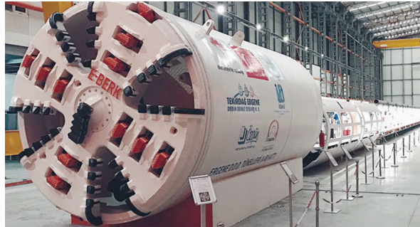
Şekil 17: Kazılarda kullanılan tünel açma makinesi
